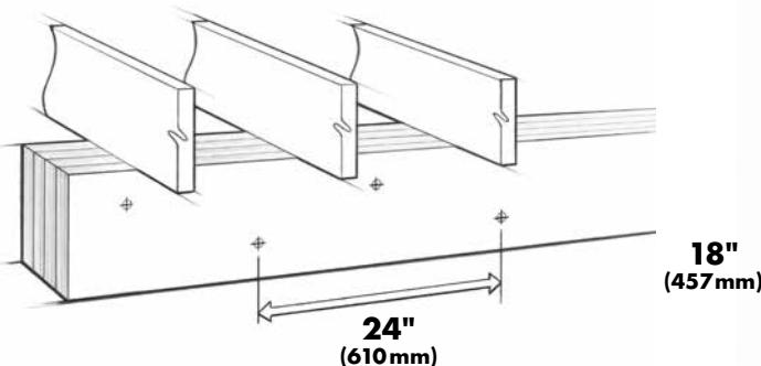
Pour les poutres de 18 po de profondeur et plus, posez 3 fixations FlatLOK à tous les 24 po, au centre.
